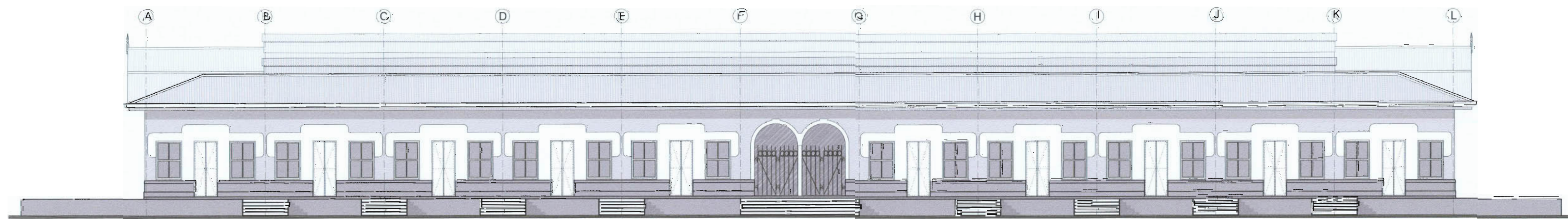
FACHADA SUR EXISTENTE ORIGINAL en eje 1. esc. 1:125 Esta fachada no se aprecia en el sitio dado que se encuentra detras de multiples adiciones de chinamos, laminas HG, aleros y precintas ajenos a la estructura original
