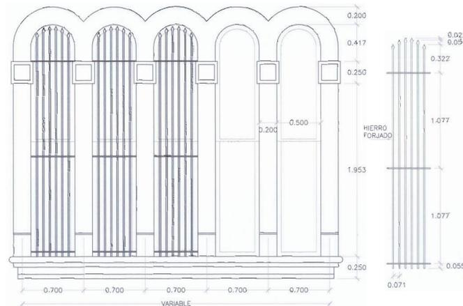
DETALLE DE VENTANAS TIPO 2 ESCALA 1:20
