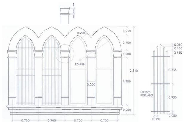
DETALLE DE VENTANAS TIPO 1 ESCALA 1:20
