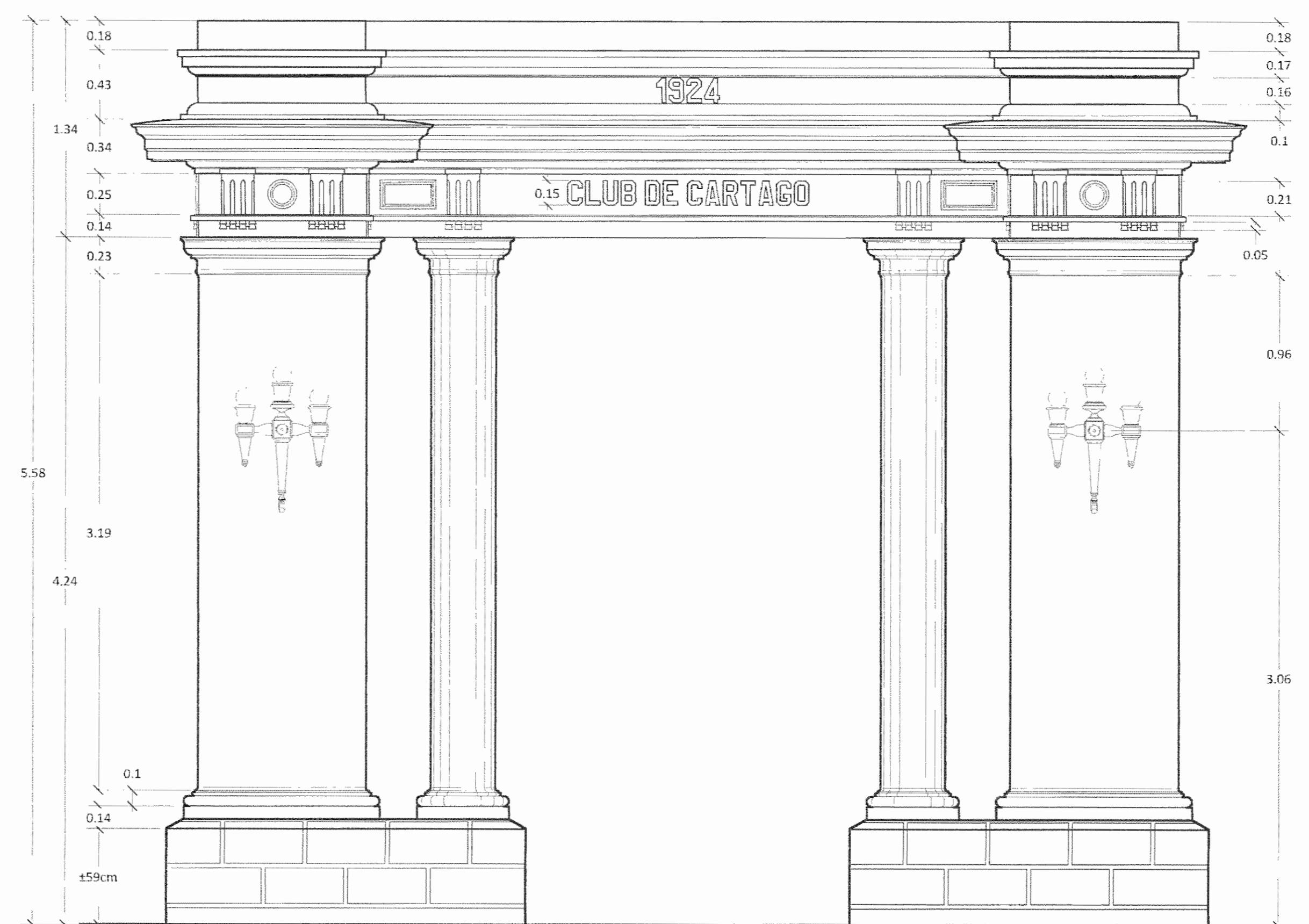
DETALLE ELEVACION DE PORTICO Escala 1:25
