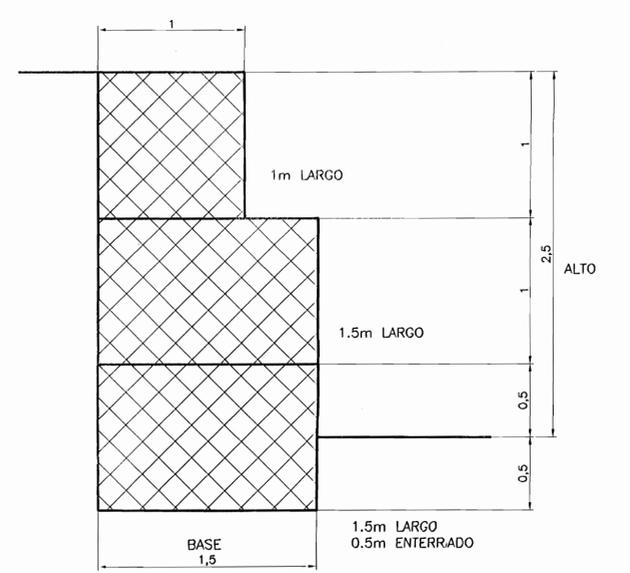
MURO DE GAVIONES ESC. 1:25
