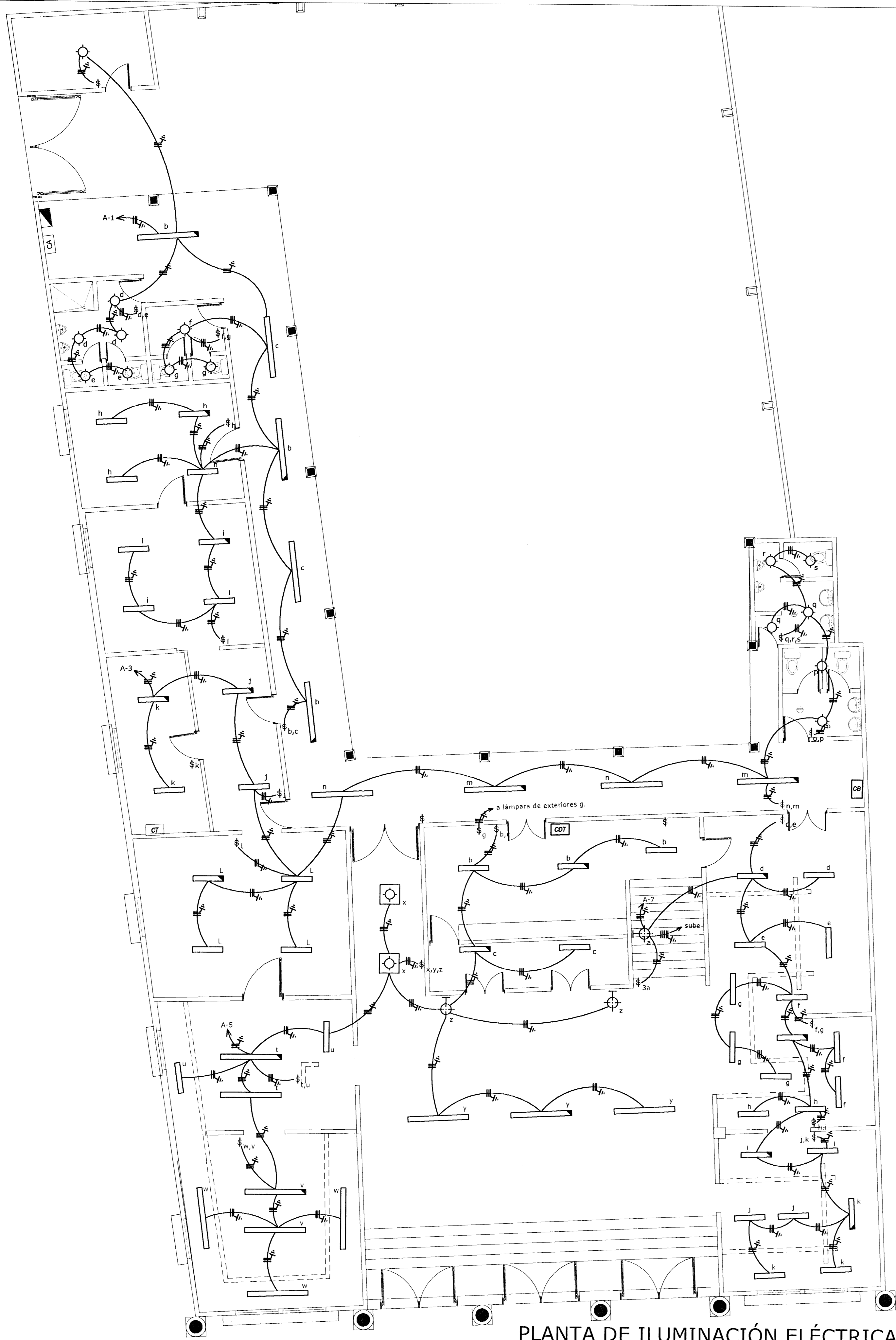
PLANTA DE ILUMINACIÓN ELÉCTRICA NIVEL 1 ESCALA: 1:75
