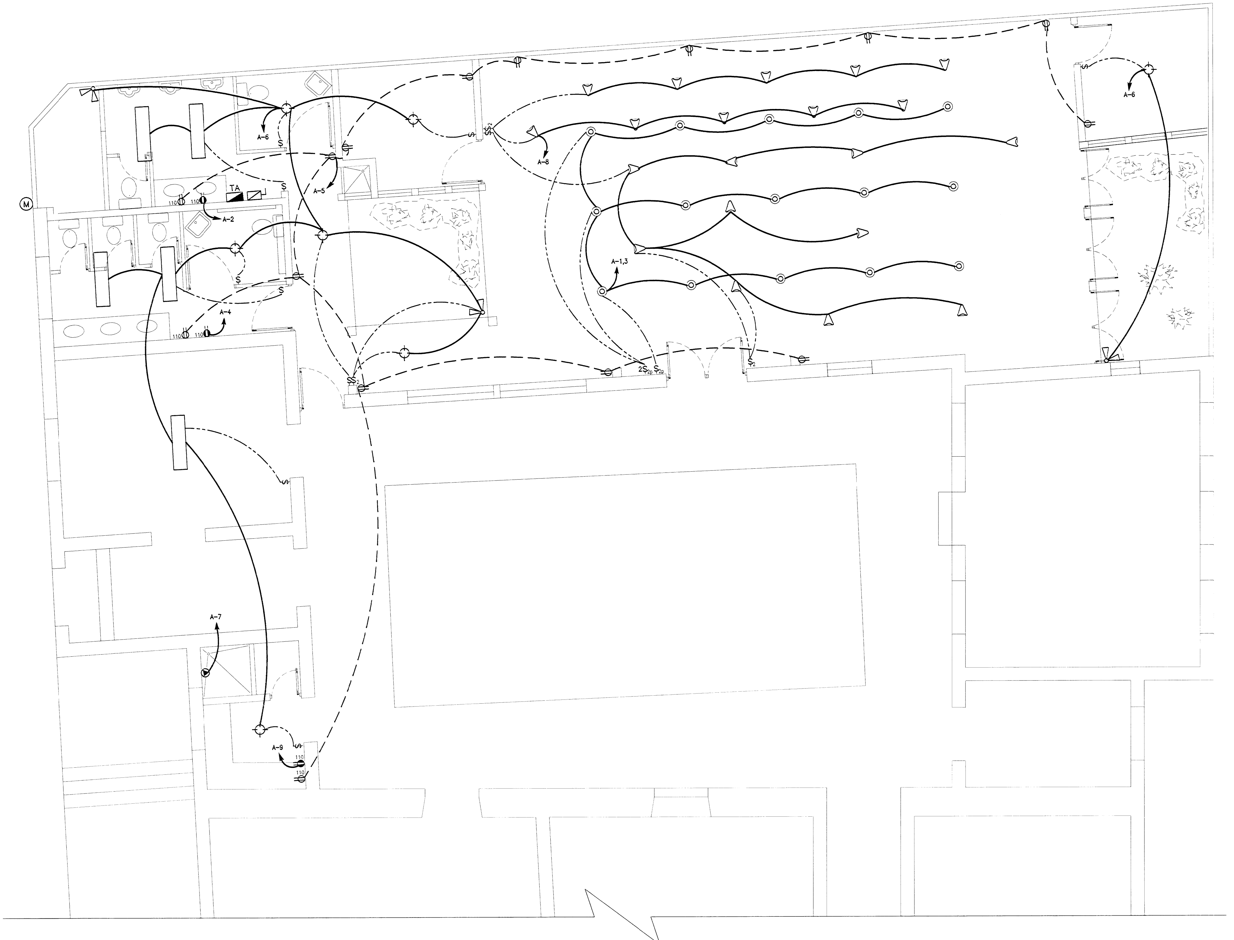
PLANTA DE DISTRIBUCION ELECTRICA Escala 1:50
