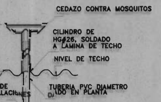
DETALLE DE SALIDA DE VENTILACION ESCALA 1:10
