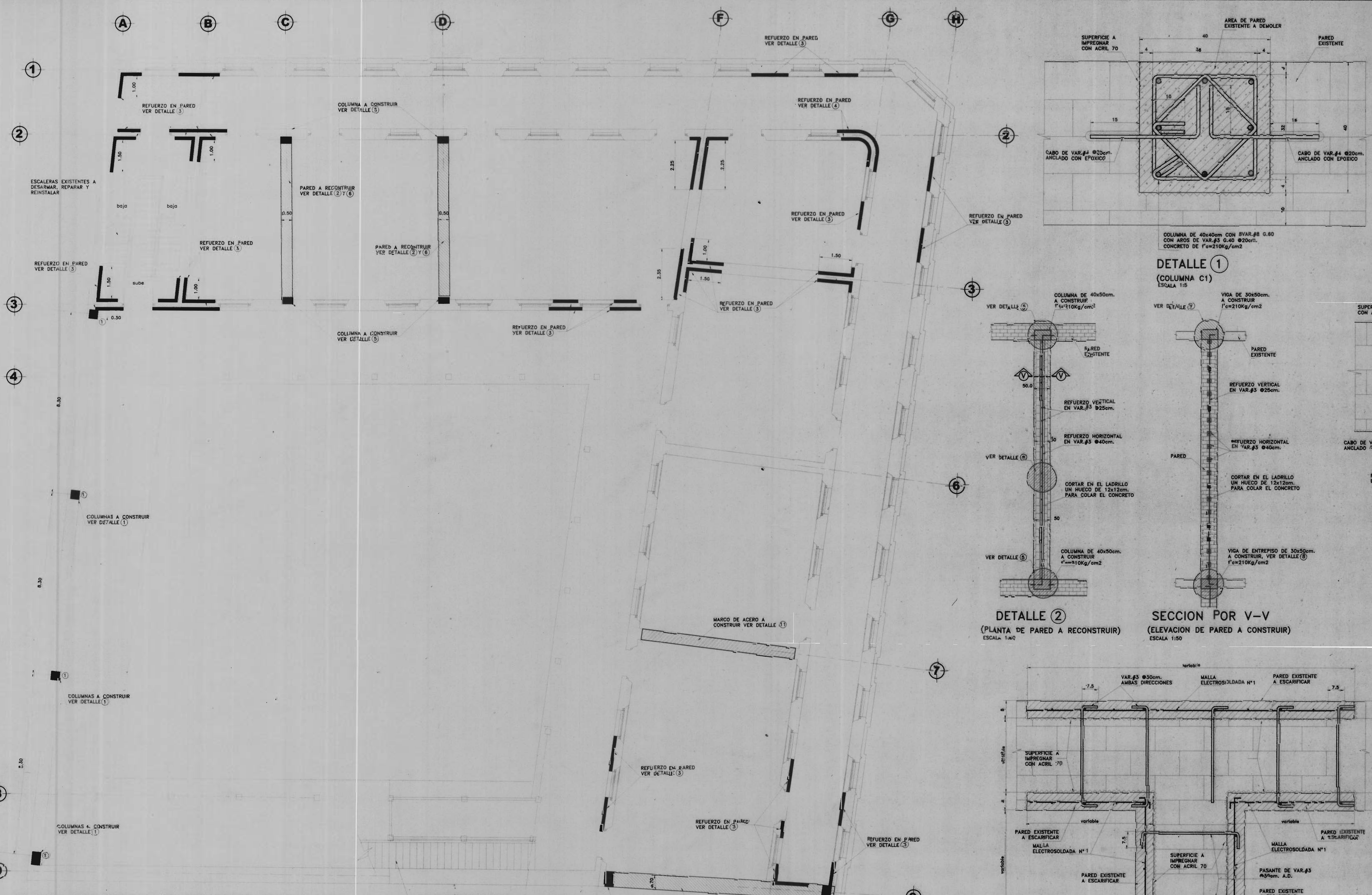
PLANTA ESTRUCTURAL DE REFUERZOS PLANTA ALTA ESCALA 1:7.5
