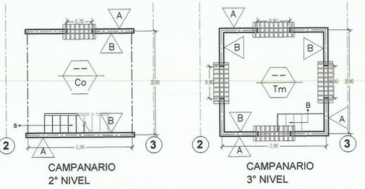
PLANTA DE DISTRIBUCIÓN ARQUITECTÓNICA ESTADO ACTUAL Y DAÑOS ESC 1/50
