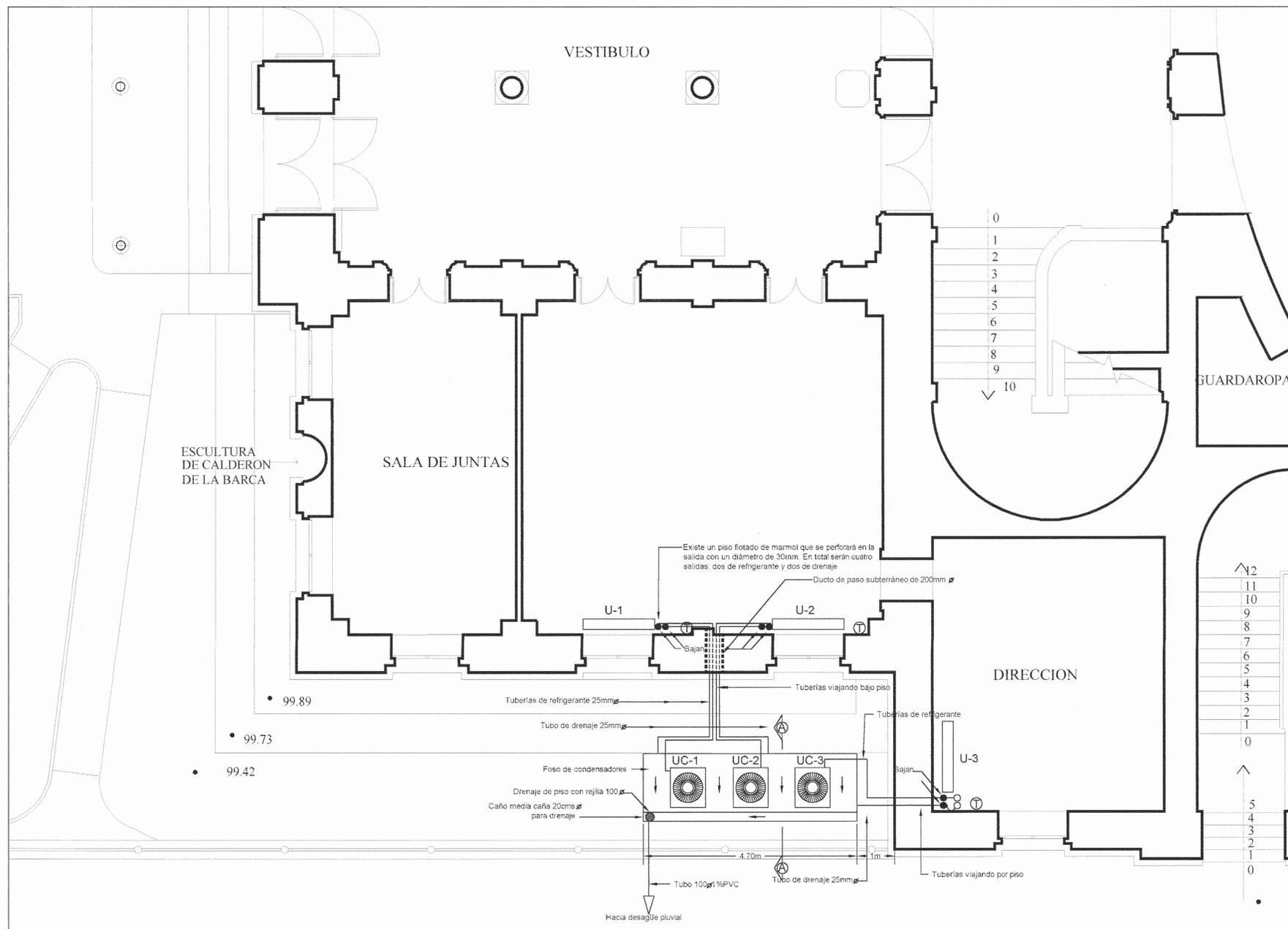
UBICACION EN PLANTA DEL SISTEMA DE AIRE ACONDICIONADO escala: 1:400.
