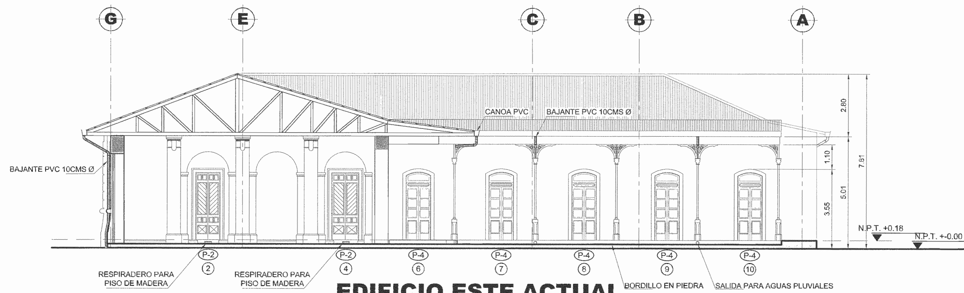
EDIFICIO ESTE ACTUAL CORTE POR D-D CONSIGNACION DE DAÑOS ESCALA 1:100
