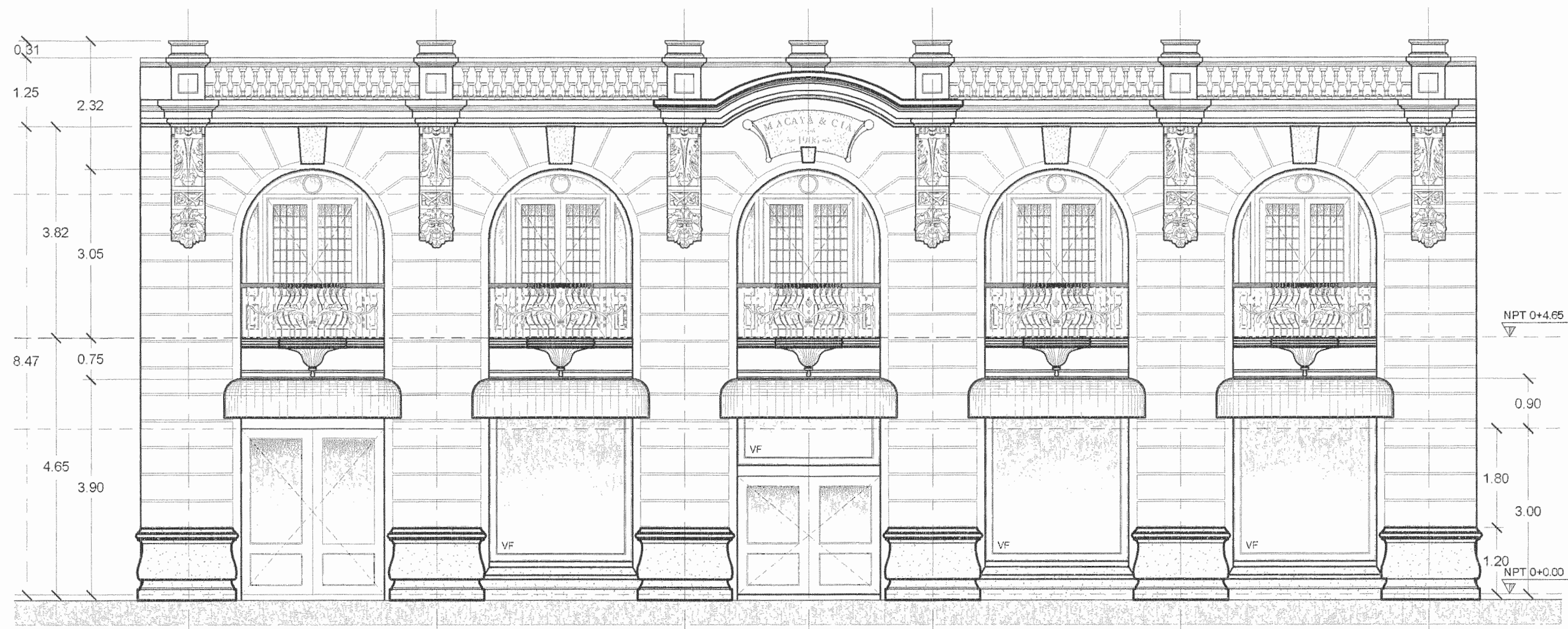
ELEVACION PRINCIPAL RESTAURADA ESCALA 1:75
