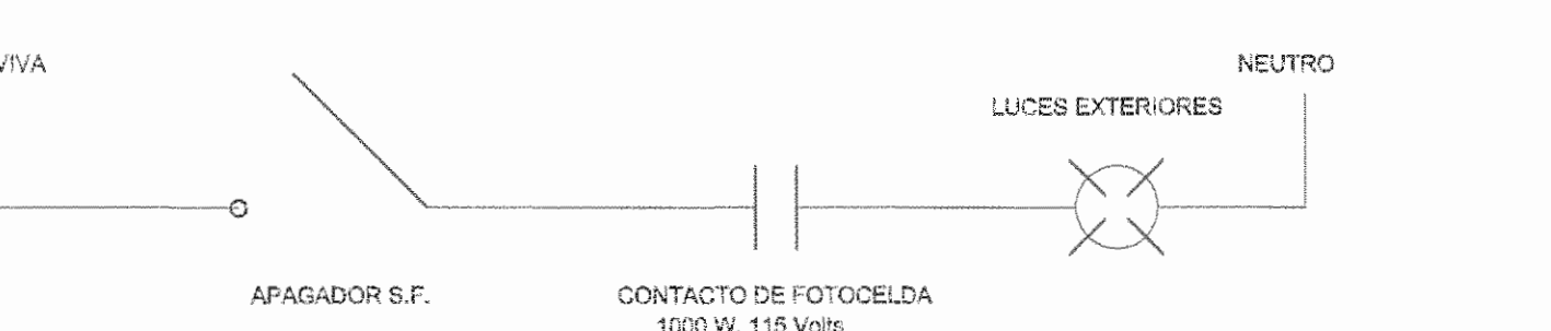
DIAGRAMA DE ALAMBRADO DE LUMINARIA CONTROLADAS FOTOCELDAS (F) (EXTERIORES) SIN ESCALA
